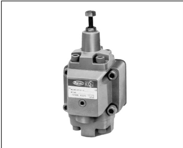
该阀在通过对控制压力的控制，对液压回路的工作顺序进行控制（顺序工作），或将泵压力由负载状态调节为空载状态（卸荷工作）时使用。
