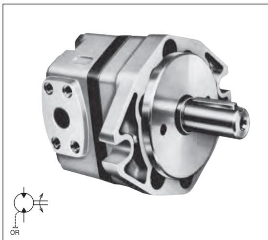
流入液体によってケーシング内がかみ合う2個の歯車が連続回転運動をし、出力軸にトルクを発生するアクチュエータです。
