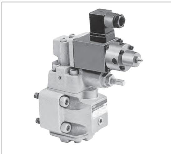
この弁はパイロット部の直流ソレノイドへの入力電流を制御することにより、圧力制御をおこなうものです。これにより、圧力は連続的、無段階に遠隔制御できます。その結果、多段圧力制御、プログラム制御、遠隔制御などが容易におこなえ、省力化、自動化および油圧装置の簡略化をはかることができます。
